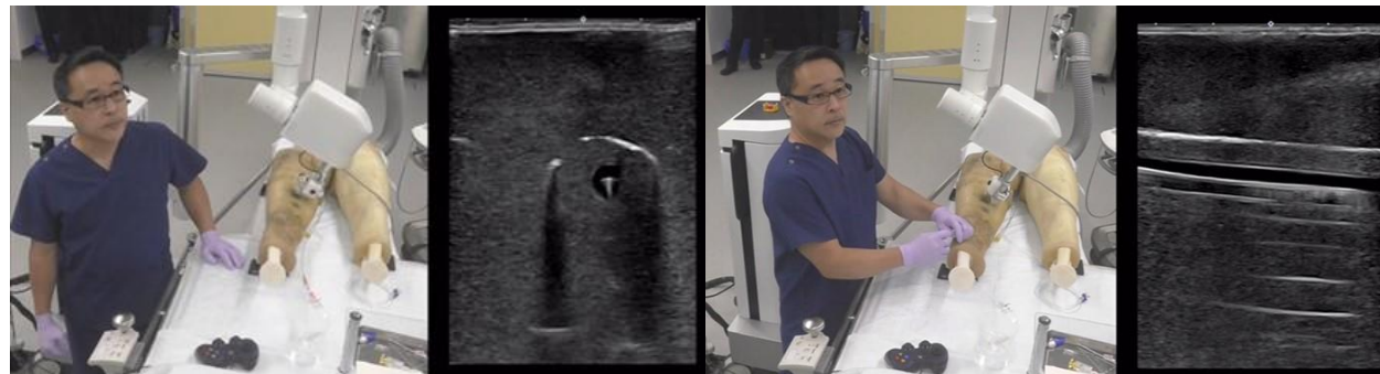
▲ロボット使用時の様子（短軸長軸の切り替え）
